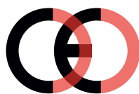
Faux marquage CE (trop proche)
